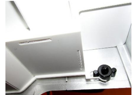
Man sieht deutlich wie der Kabinenboden von vorn mit den Haken über die Auflage im Dachausschnitt geschoben wird und wie der Kippbegrenzer platziert werden sollte. Anschließend wird der Boden vorn auf das Kippscharnier gelegt, er braucht zur leichteren Entnahme nicht weiter befestigt zu werden. Abbildungen ähnlich.
