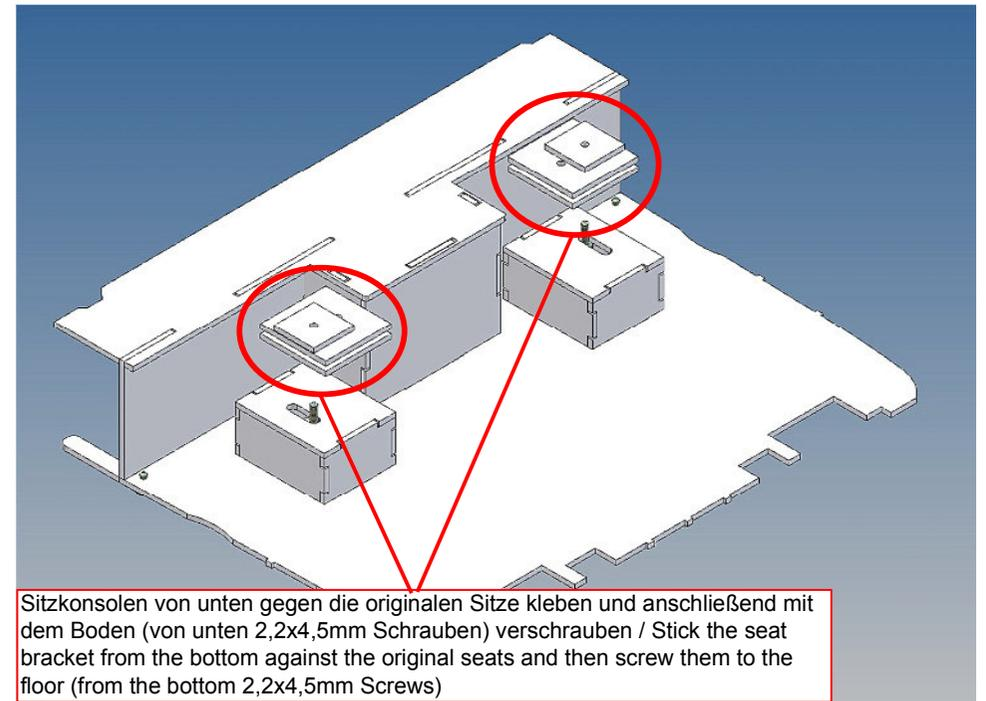
Sitzkonsolen von unten gegen die originalen Sitze kleben und anschließend mit dem Boden (von unten 2,2x4,5mm Schrauben) verschrauben / Stick the seat bracket from the bottom against the original seats and then screw them to the floor (from the bottom 2,2x4,5mm Screws)
